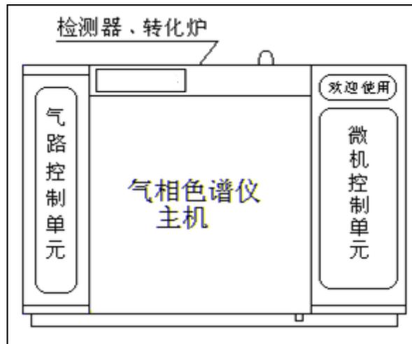
(1)气路部分：载气由稳流阀调节，压力表显示稳流阀出口压力，稳流阀前均有稳压阀，稳压阀出厂前已定值，用户不用调节。氢气，空气均由稳压阀调节，采用了气阻器及压力表显示方式。（附下图）。
